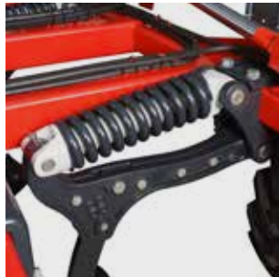
NOVA Steinsicherung mechanisch
